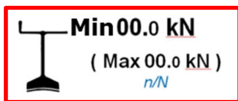
Abbildung 3: Anschrift der Bremskraft der Feststellbremse
